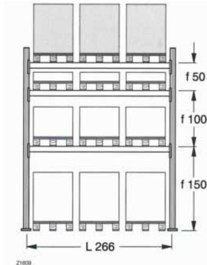
**Bestimmung der zulässigen Fach- und Feldlasten für das System CG 55x40 mit SB-Integrierung in Kombination mit dem Traversentyp 80x40**
