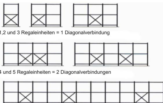
Ab 5 Regaleinheiten sind alle weiteren 5 Einheiten mit 1 Diagonalverbindung zu versehen.
